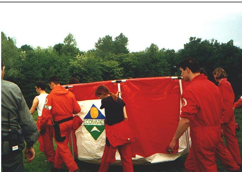
Vasca mobile componibile mod. 12L 16000, forma poligonale a 12 lati, capacità massima litri 17.800, ampiezza massima cm. 456, altezza telaio cm. 131, altezza livello acqua cm. 120 circa.
